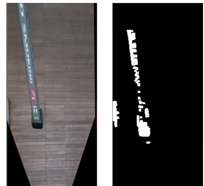
図3 障害物検出実験の結果 左: 鳥瞰画像 右: 差分画像
